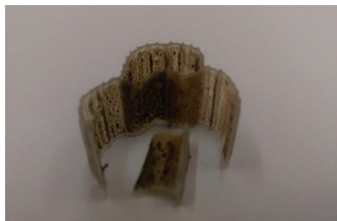
شکل ۳) چگونگی رشد لایه زیستی بر روی بستر K1
