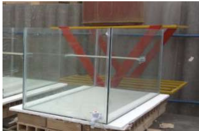
شکل ۱) نمونه‌ای از پایلوت شیشه‌ای با ابعاد ۱۰۰*۵۰*۶۰ سانتی متر
